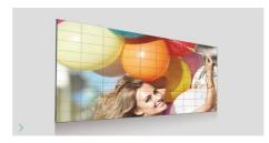
Le kit d'étalonnage avancé des couleurs commande la luminosité du rétroéclairage, normalise la courbe gamma et effectue un étalonnage automatique des niveaux de gris. Quelle que soit votre configuration (mur vidéo gigantesque, mosaïque, affichage de menus sur écran ou salle de contrôle), vous pouvez régler chaque écran sur les mêmes paramètres de couleur. Ce kit en option permet d'uniformiser les couleurs sur tous les écrans de votre réseau.
